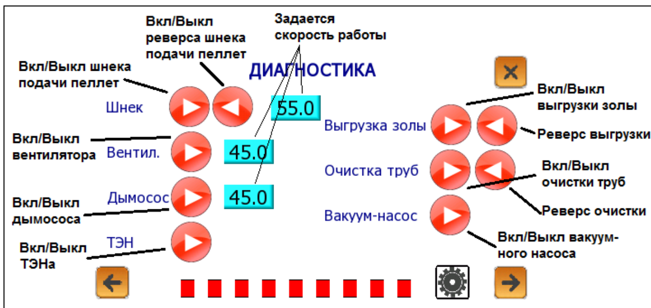
Рис. 25. Включение отдельных агрегатов котла
