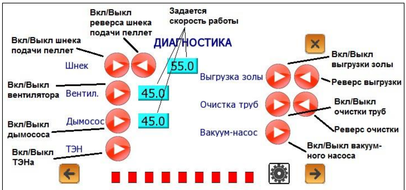
Рис. 25. Включение отдельных агрегатов котла
