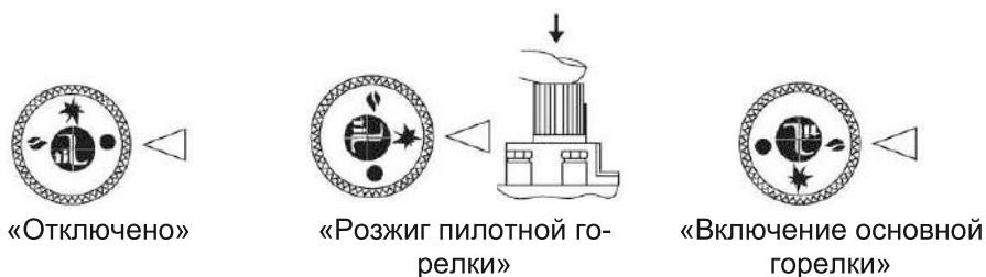
Рисунок 3 - Элементы управления на газовом блоке 820 NOVA mV.
