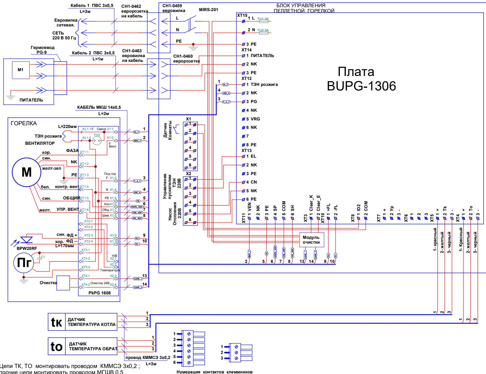
Рис. 8. Схема монтажная.
