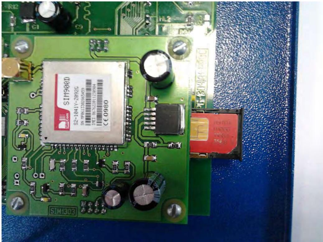
Рис.6.5. Установка лотка на место.
