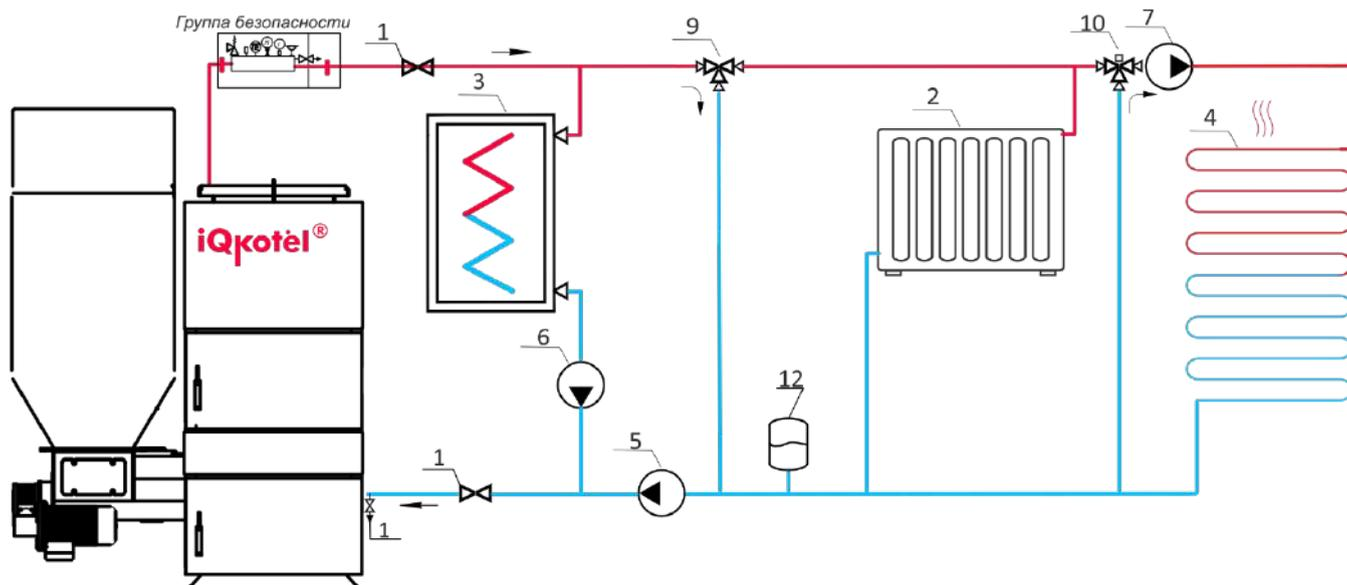
Рис. 1. Упрощенная схема подключения iQkotel с термостатическим клапаном: iQkotel, Группа безопасности
