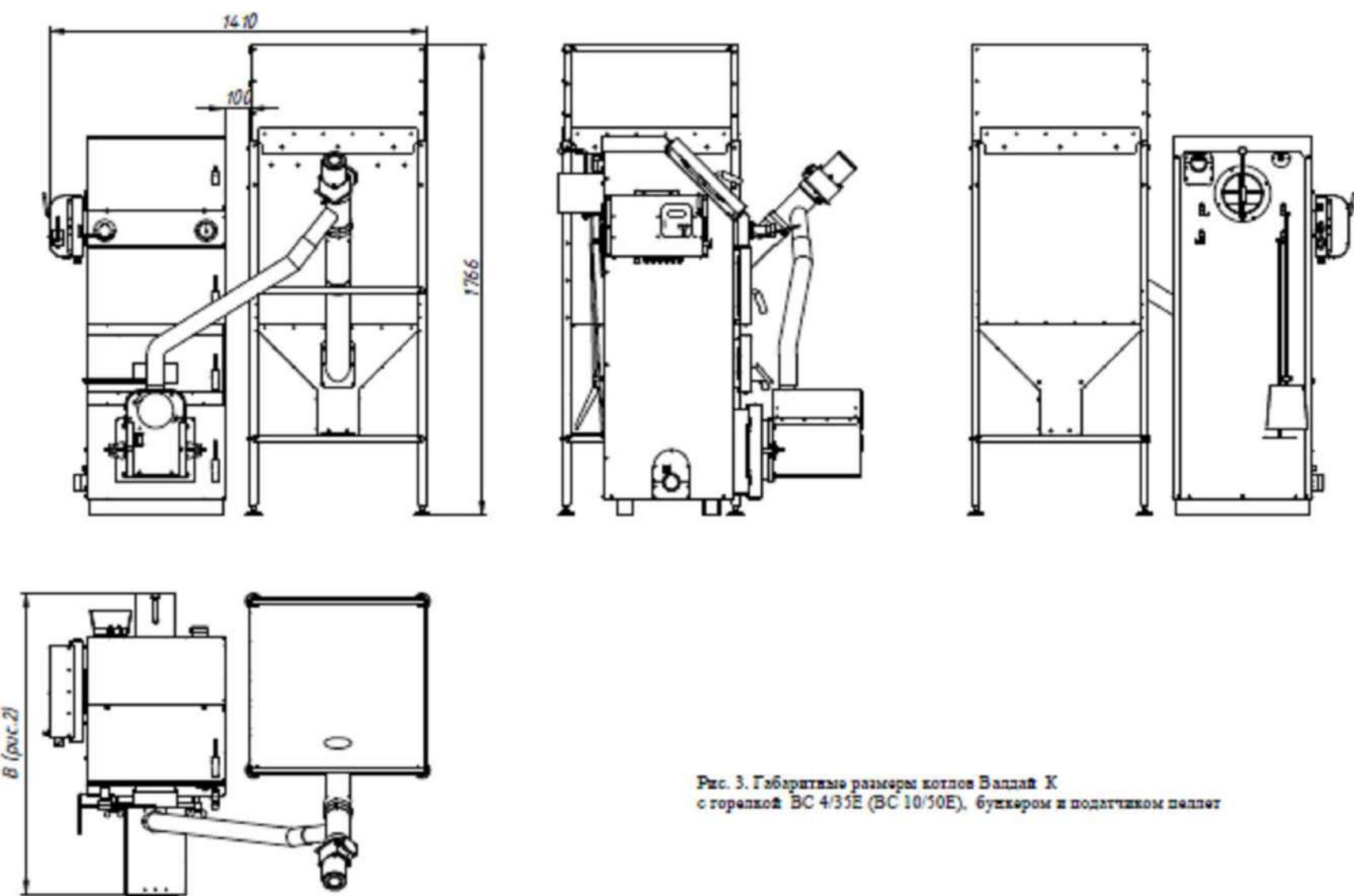
Рис. 3. Габаритные размеры котлов Валдай К
