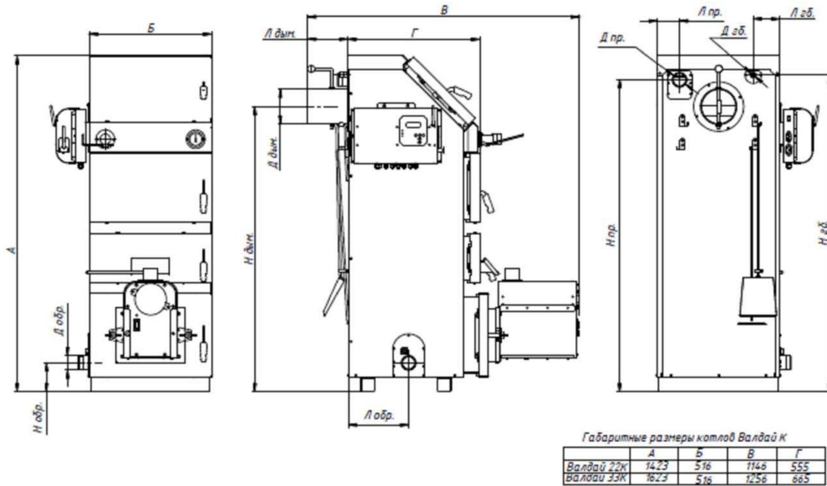
Рис. 2. Габаритные и присоединительные размеры котлов Валдай 22К и Валдай 33К (для котла Валдай 15К на рис.1а)
