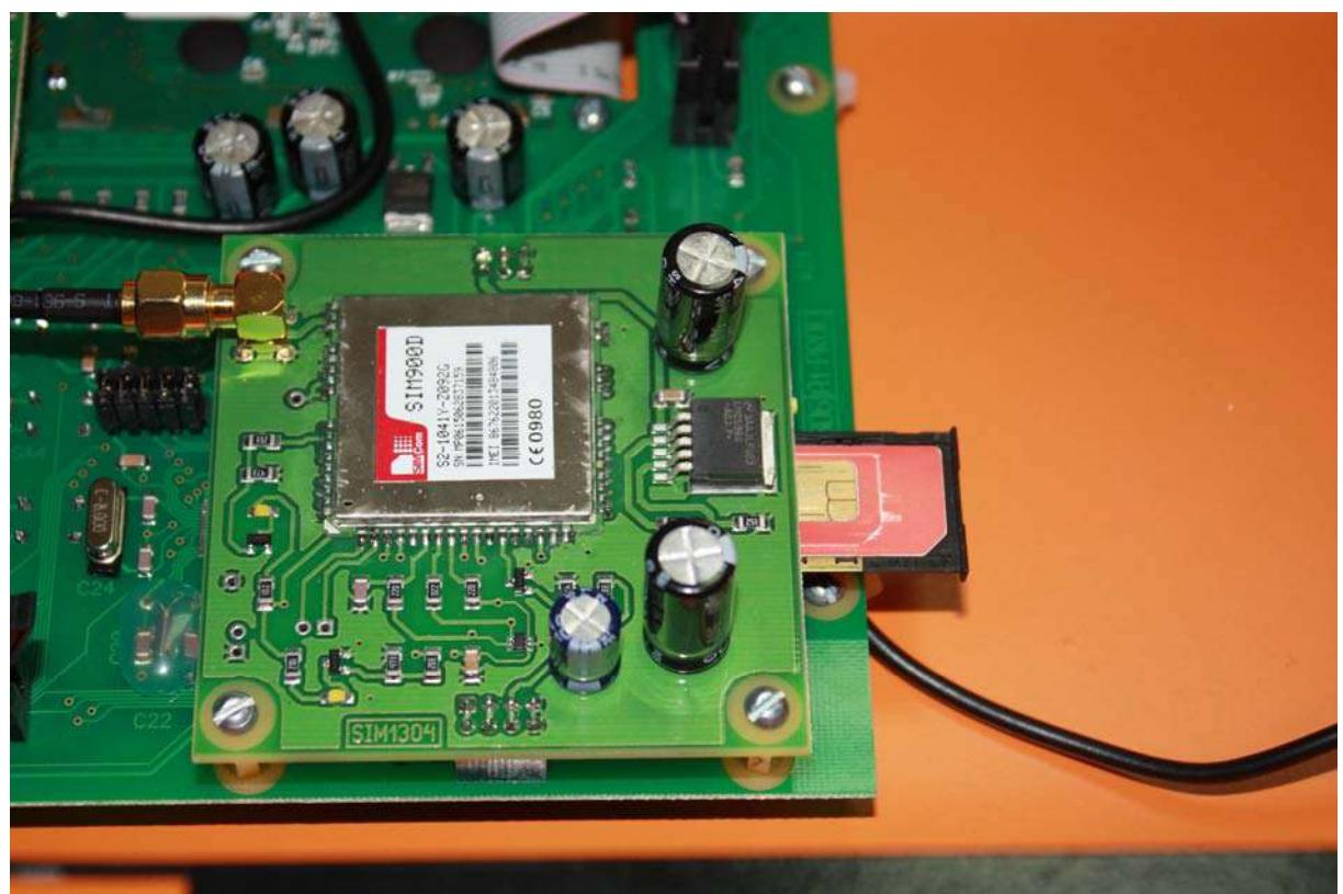
Рис.8.1. Установка лотка на место.
