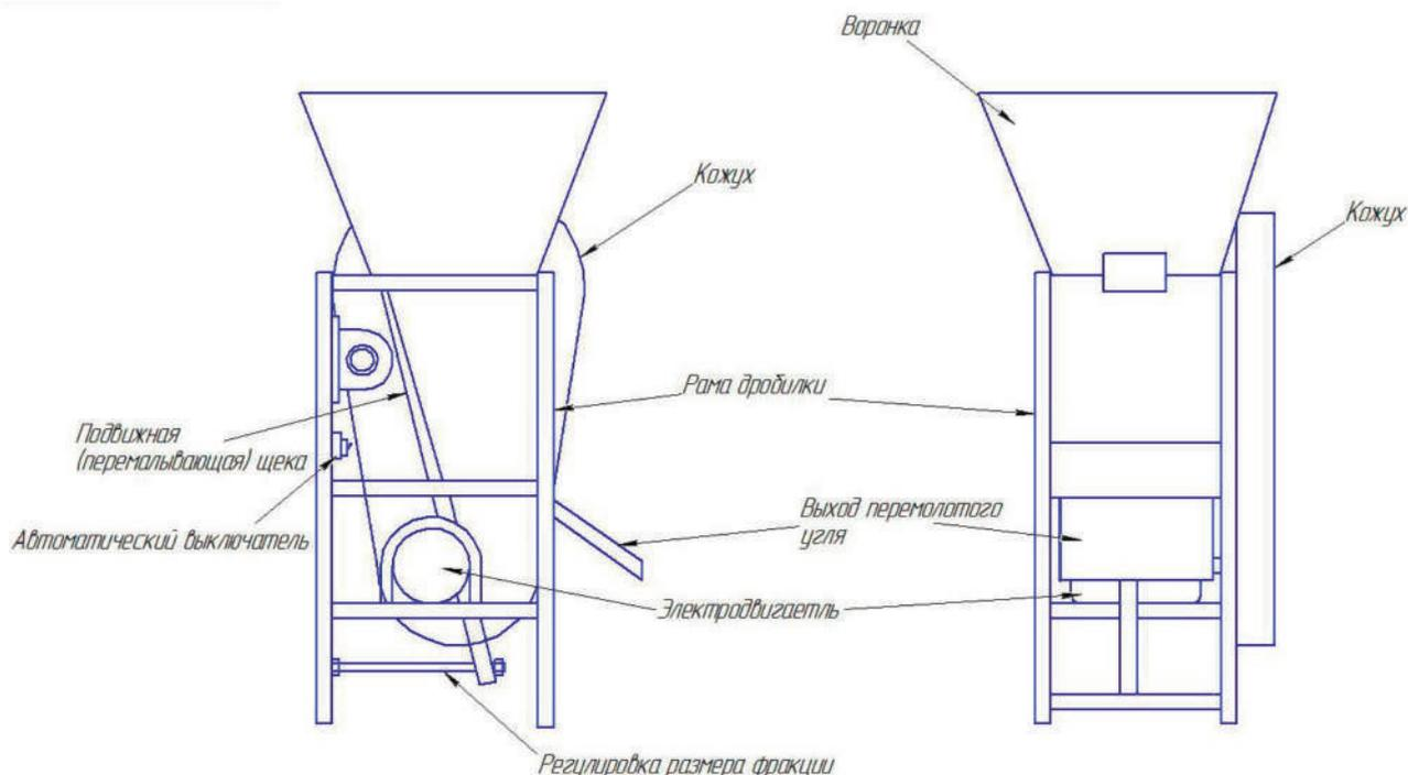
Щековая дробилка относится к дробильному оборудованию, предназначенному для размола исходного материала путем его сжатия между двумя щеками. После включения дробилки уголь засыпается в воронку и перемалывается между двух щёк имеющих вертикальные рёбра по всей длине. Одна щека зафиксирована на раме сварными соединениями, вторая приводится в действие при помощи шатуна. Вал шатуна приводится в действие электродвигателем установленным в нижней части дробилки через ремённую передачу.
