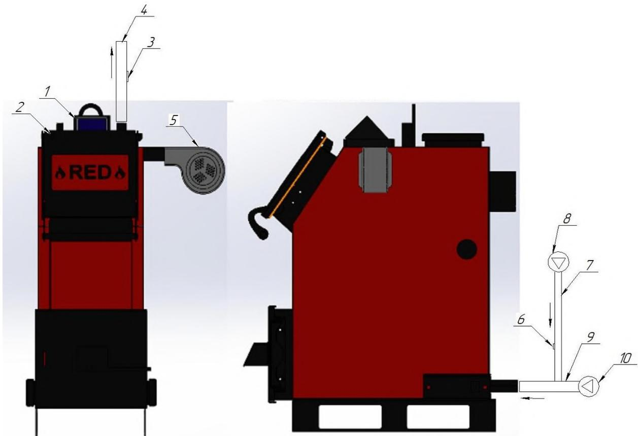
Рисунок 7 — Схема подключения блока управления к котлу. 1-контроллер (подключается к сети 220В); 2-датчик системы отопления (устанавливается в гильзу); 3-аварийный датчик (термик); 4-труба подачи; 5-вентилятор наддува; 6-датчик горячего водоснабжения (ГВС); 7-труба обратной подачи от бойлера ГВС; 8-насос ГВС; 9-труба обратной подачи от отопления; 10-насос системы отопления
