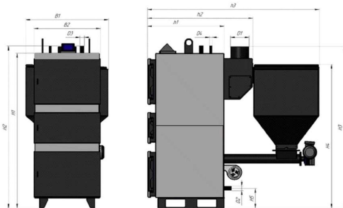
Рисунок 2. Габаритные размеры ФЕНИКС Z
