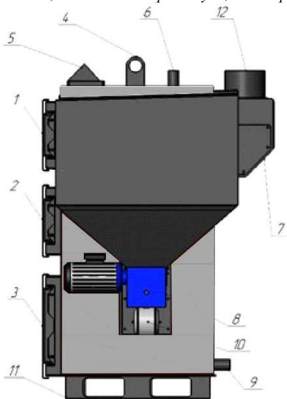
Рисунок 6 — Схема размещения составных элементов в котлах серии ФЕНИКС (вид сбоку). 1-дверца теплообменника; 2-дверца горелки; 3-дверца зольника; 4-ухо транспортировочное; 5-контроллер; 6-труба подачи; 7-короб дымохода; 8-мотор-редуктор; 9-труба обратной линии; 10-вентилятор наддува; 11-опора котла; 12-дымовая труба.
