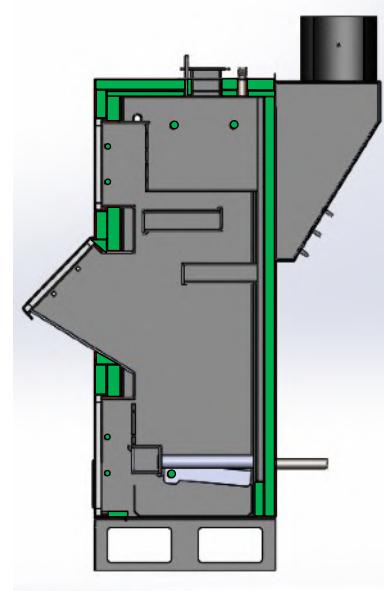
Теплообменник котла трехходовой, горизонтальный. Колосники котла являются водонаполненными и включены в водяной контур котла. Управляет температурой на подаче микропроцессорный контроллер, который регулирует подачу воздуха в топку посредством вентилятора наддува. Вентилятор наддува устанавливается сверху котла на канал подачи воздуха, который проходит под обшивкой котла и прилегает к водяной рубашке котла, за счет чего подаваемый в топку воздух перед подачей подогревается.
