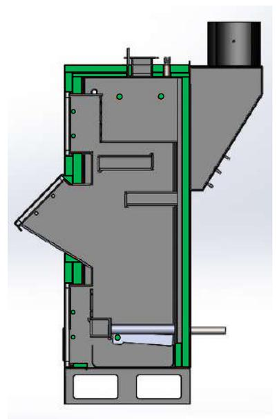
Теплообменник котла трехходовой, горизонтальный. Колосники котла являются водонаполненными и включены в водяной контур котла. Управляет температурой на подаче микропроцессорный контроллер, который регулирует подачу воздуха в топку посредством вентилятора наддува. Вентилятор наддува устанавливается сверху котла на канал подачи воздуха, который проходит под обшивкой котла и прилегает к водяной рубашке котла, за счет чего подаваемый в топку воздух перед подачей подогревается.
