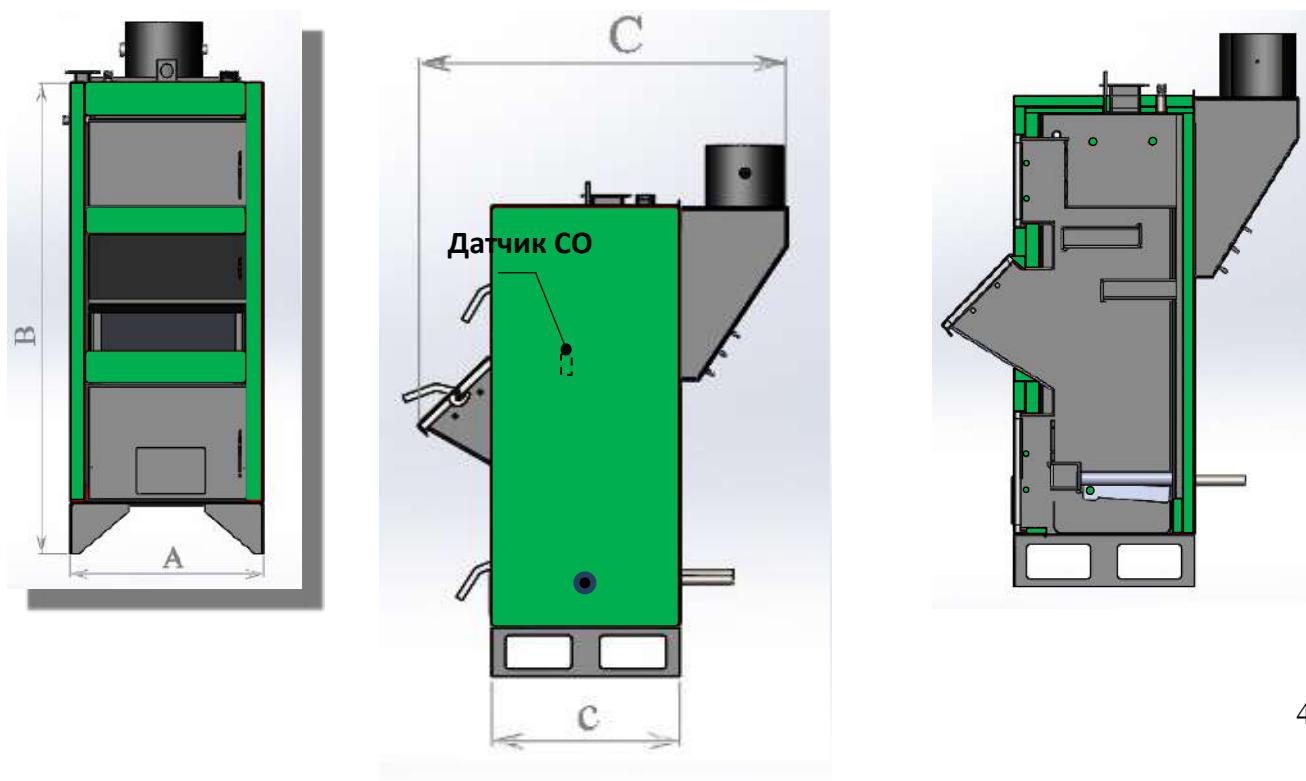
Теплообменник котла трехходовой, горизонтальный. Колосники котла являются водонаполненными и включены в водяной контур котла. Управляет температурой на подаче микропроцессорный контроллер, который регулирует подачу воздуха в топку посредством вентилятора наддува. Вентилятор наддува устанавливается сверху котла на канал подачи воздуха, который проходит под обшивкой котла и прилегает к водяной рубашке котла, за счет чего подаваемый в топку воздух перед подачей подогревается.
