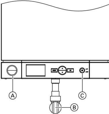
1. Проверить давление отопительной установки по манометру (A). **Минимальное давление установки 0,8 бар (0,08 МПа)**
