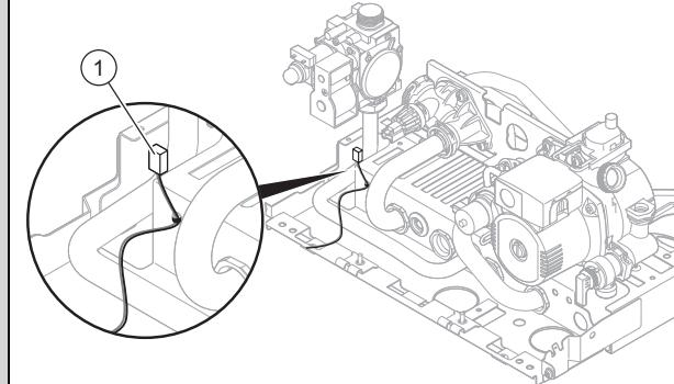
Подключите датчик температуры накопителя к белому штекеру (1). в жгуте проводов гидравлического блока.
