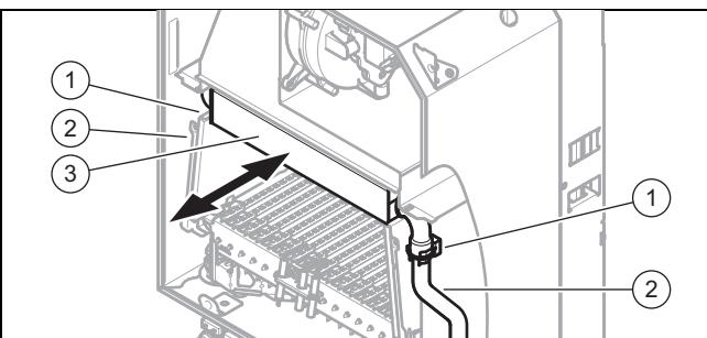
3. Снимите скобы (1). на трубе подающей и обратной линии.
