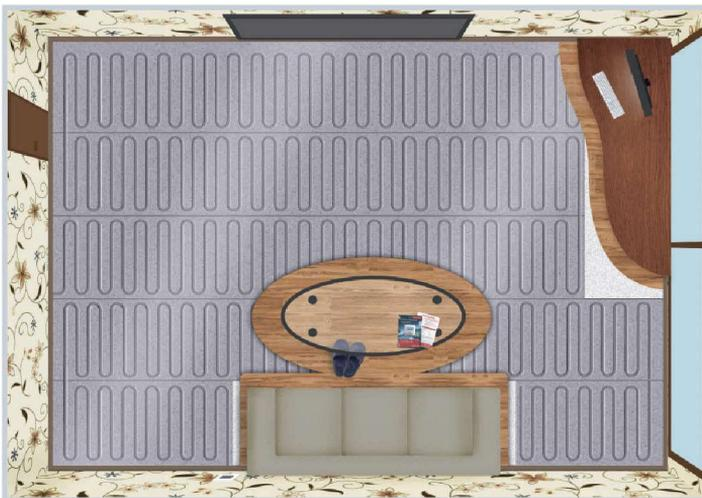
Нагревательный мат Thermomat LP укладывается сверху подложки по всей площади помещения, если площадь обогрева меньше общей площади помещения, то в местах, где не уложен нагревательный мат, укладывается еще один слой подложки (пенополиэтилен) толщиной 3 мм.
