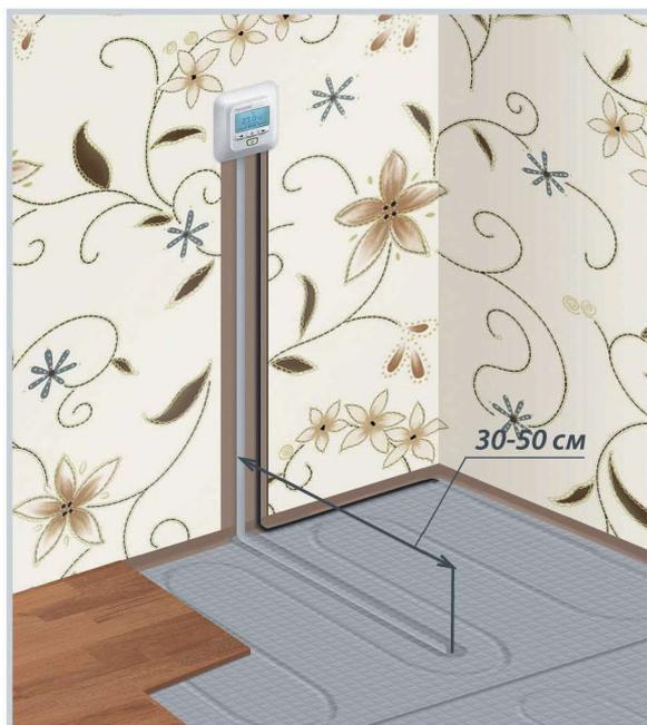
Схема укладки датчика температуры в гофрированной трубке
