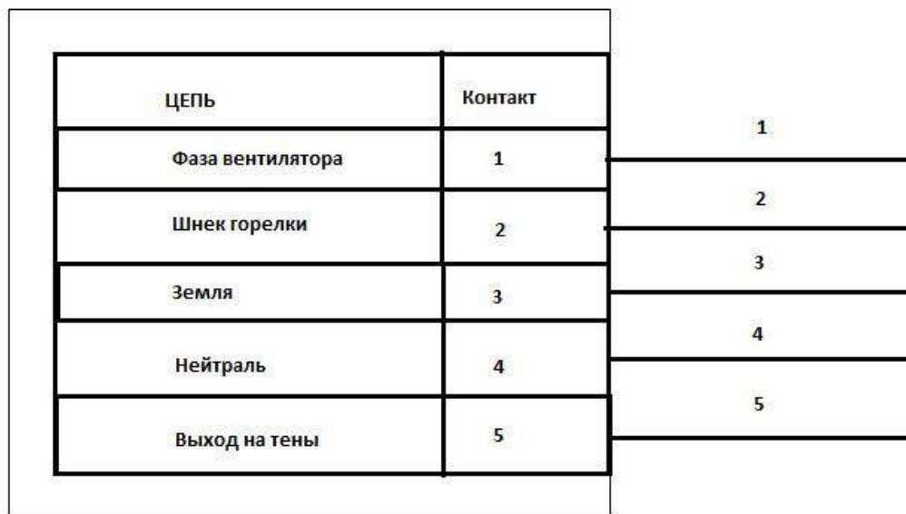
Рисунок 6 – Схема подключения к разъёму GST18I5
