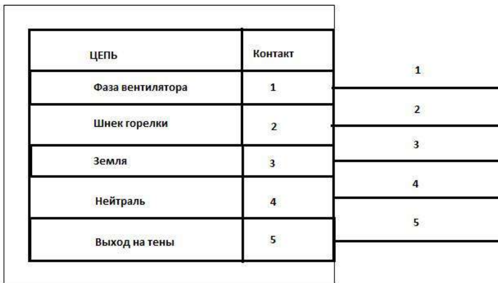
Рисунок 6 – Схема подключения к разъёму GST18I5
