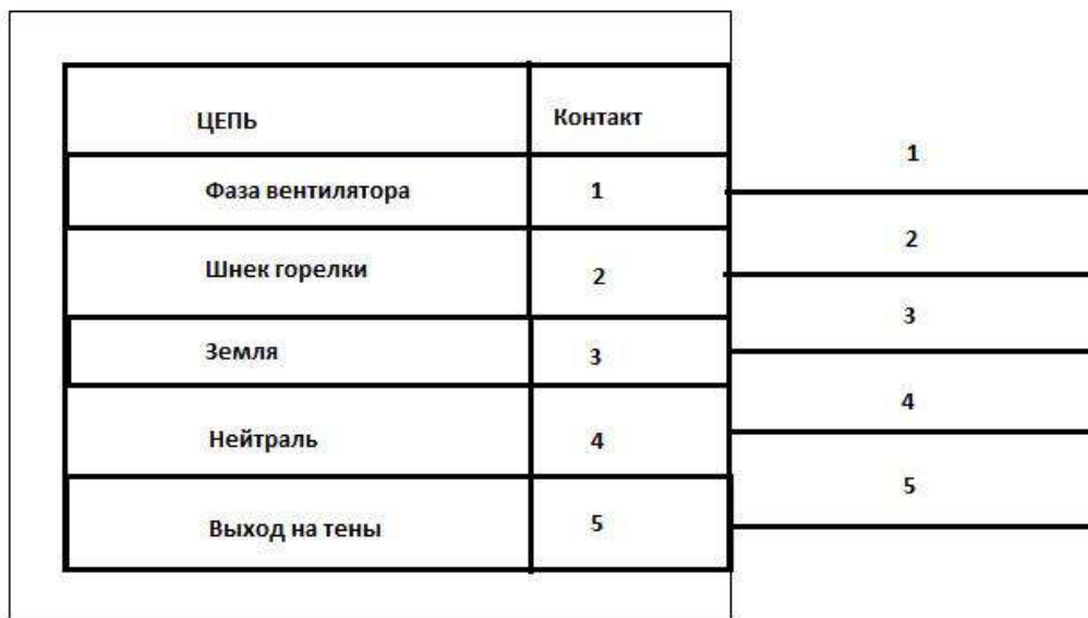
Рисунок 6 – Схема подключения к разъёму GST18I5
