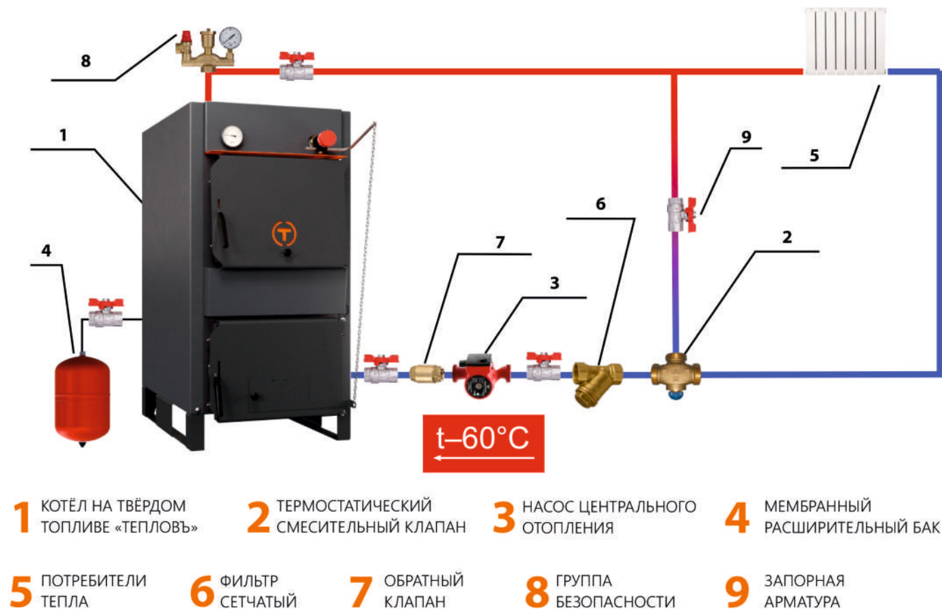
Рисунок 6. Типовая схема обвязки котла «ТЕПЛОВЪ» с 3-х ходовым клапаном
