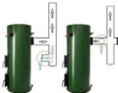
Рис. 7 Варианты установки автоматического регулятора тяги
