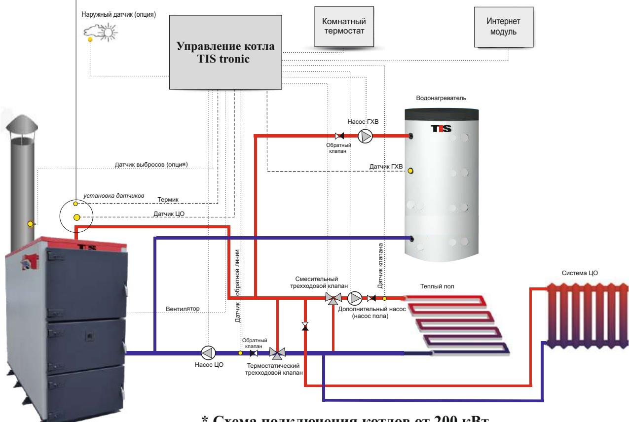
\* Схема подключения котлов от 200 кВт
