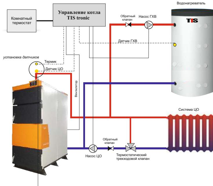
В погружную гильзу вначале опускается датчик центрального отопления, а за ним датчик термозащиты. Как вариант, допускается установка датчика термозащиты на патрубке подающего трубопровода котла (до гайки подключения), при этом, прижатие его к патрубку должно выполняться металлическим хомутом. Добавление каких-либо жидкостей в погружную гильзу запрещено!
