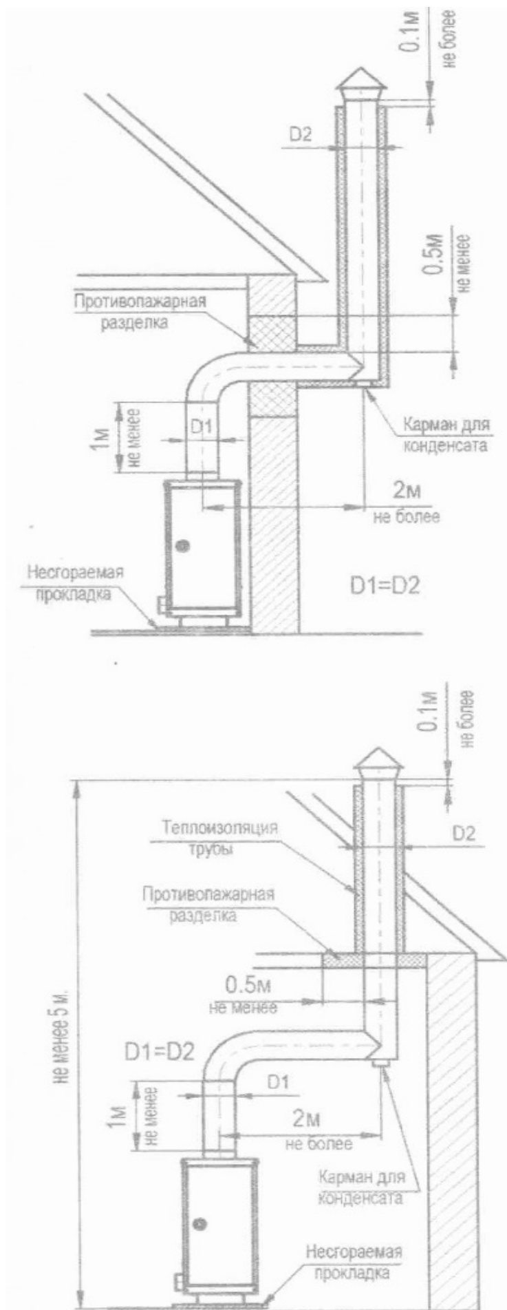
Рис. 4. Схема установки дымовой трубы с выводом через стену и с выводом через потолочное покрытие.
