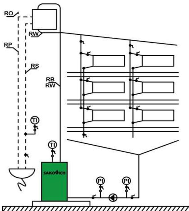
Рис. 5. Пример схемы открытой системы водяного отопления, насос установлен на возврате
