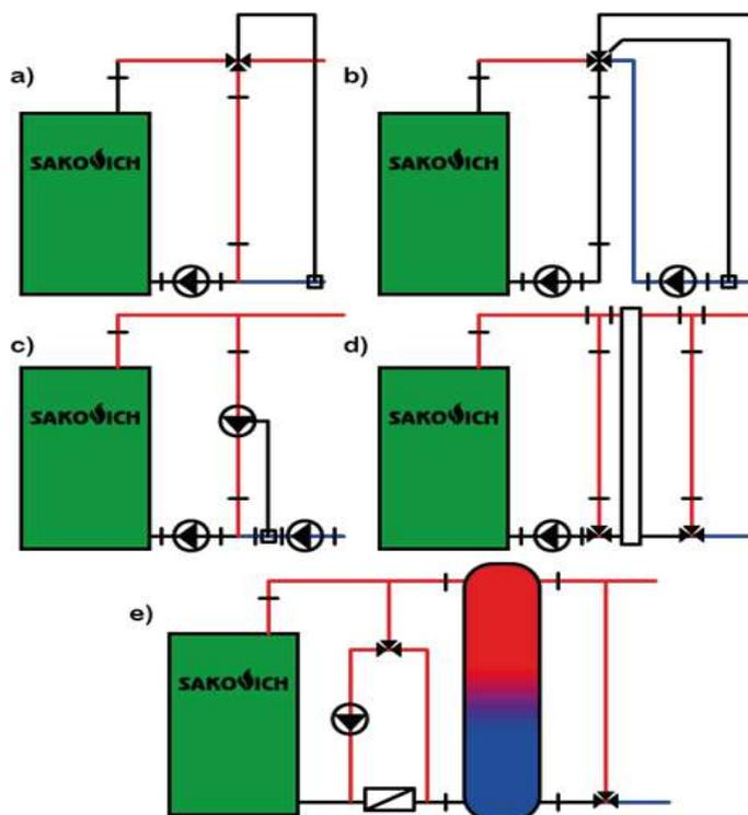
Рис 4. Рекомендуемые схемы соединения котла с системой отопления:
