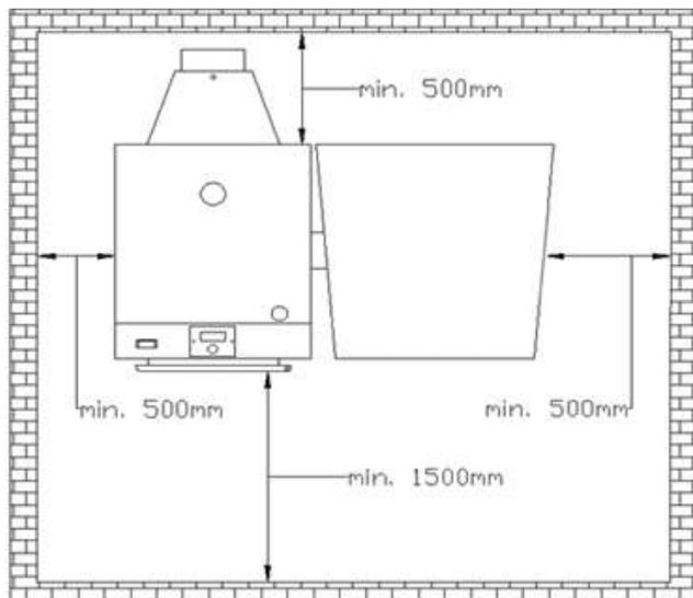
Рис.3 Установка котла в котельной
