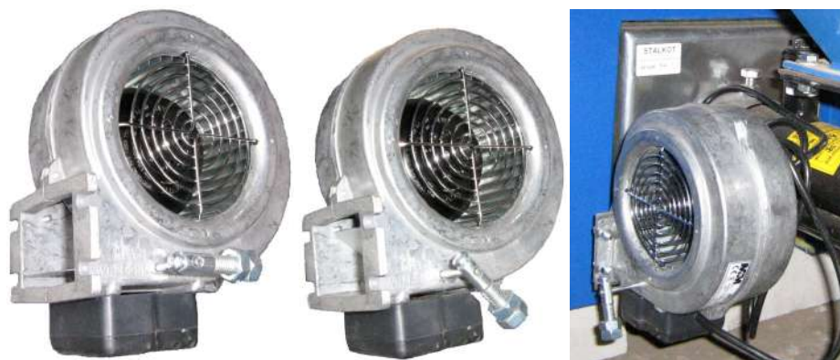
Рисунок 6 – Регулировка положения заслонки вентилятора
