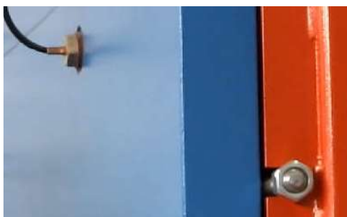
Рисунок 4 – Установка датчика температуры
