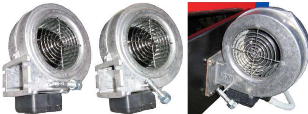
Рисунок 3 – Регулировка положения заслонки вентилятора
