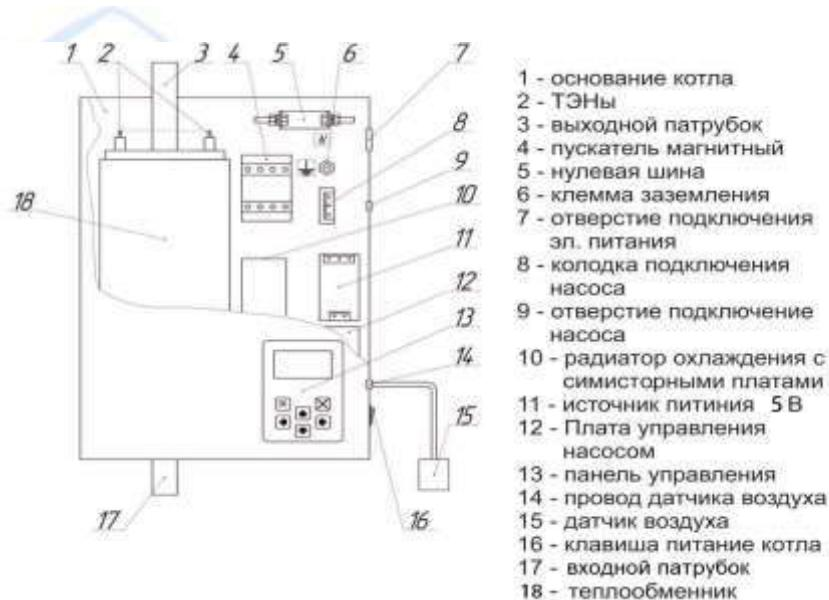
Рисунок 1. Устройство отопителя РЭКО серии П
