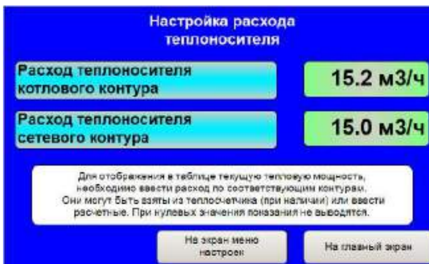
Рис 6.12. Настройка расхода теплоносителя.
