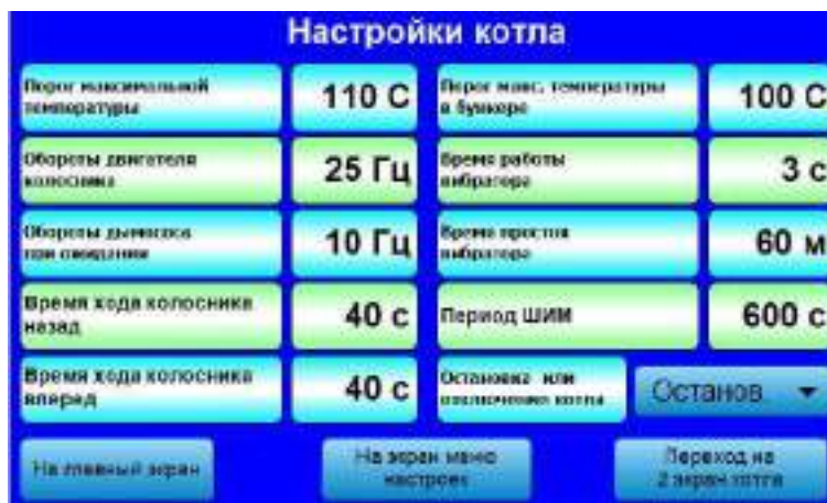
Рис 6.6. Экран настроек котла.
