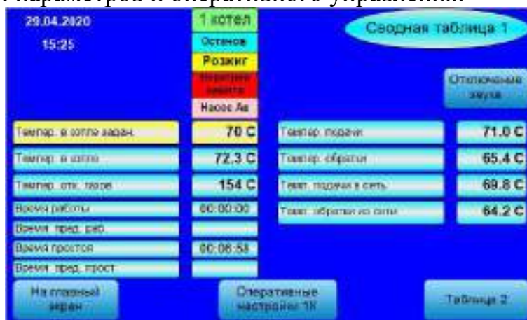
Рис 6.2. Сводная таблица текущих параметров работы котлов.
