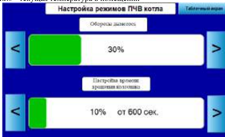
Рис 6.4. Экран оперативной настройки режима «Нагрев» котла.
