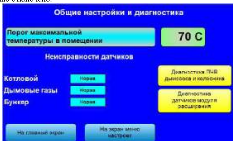
Рис 6.8. Экран общих настроек и диагностики датчиков и ПЧВ.
