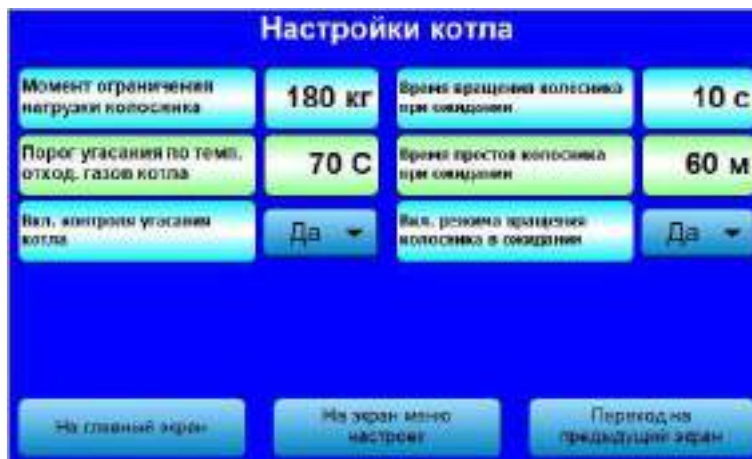
Рис 6.7. Экран настроек котла
