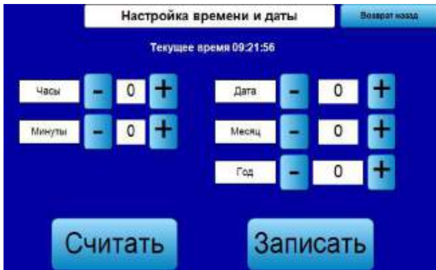
Рис 6.14. Экран настройки даты и времени на контроллере.
