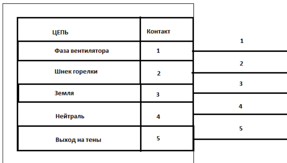
Рисунок 6 – Схема подключения к разъёму GST18I5
