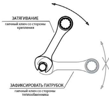
Рис. 5. Подключение к системе подачи теплоносителя
