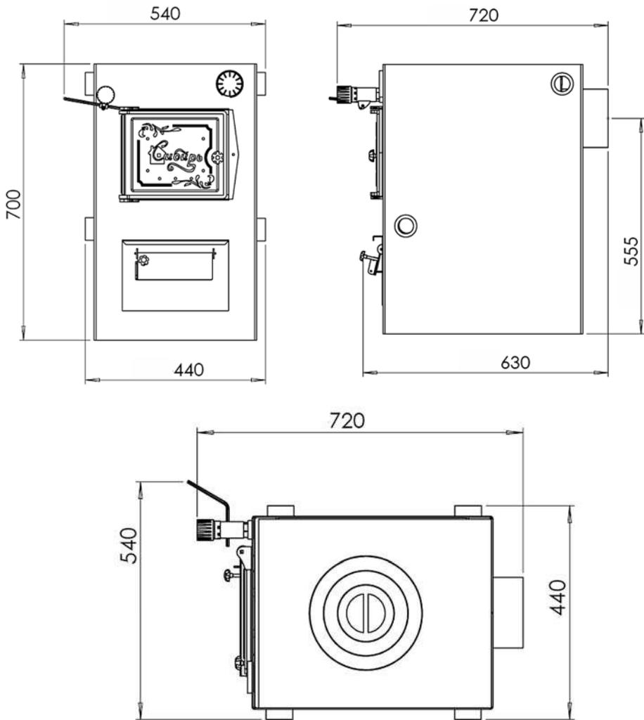
Рис.2. Габаритные размеры котла «Сибирь-КВО-Д» 10 кВт
