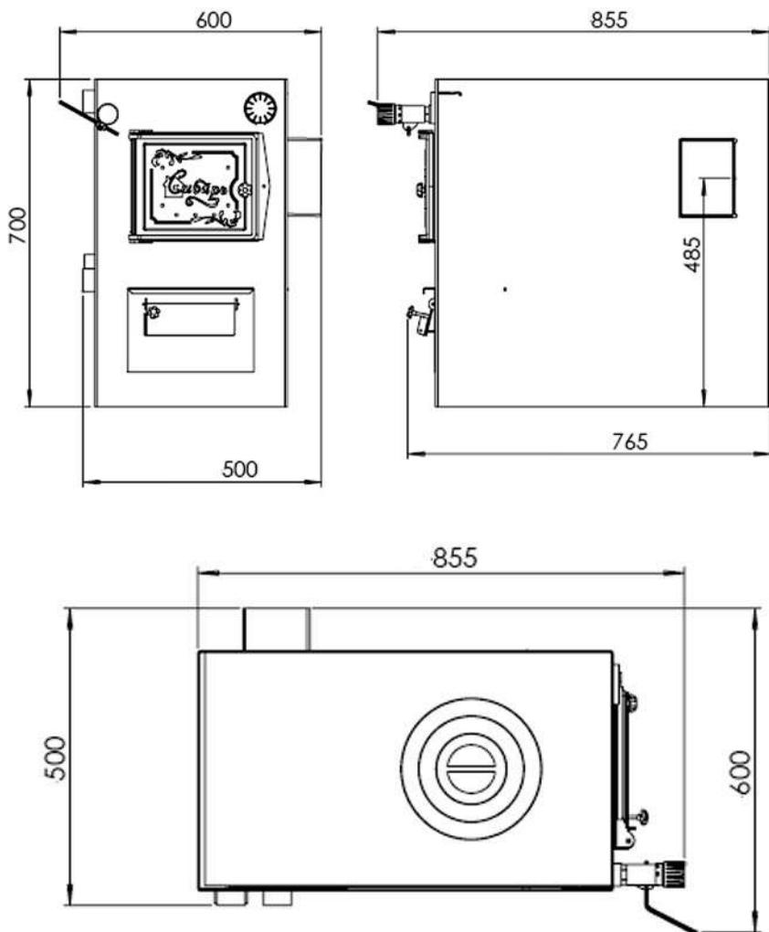
Рис.3. Габаритные размеры котла «Сибирь-КВО-Д» 12 кВт выход дымохода справа
