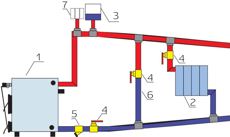
Подключение котла к системе с естественной циркуляцией теплоносителя:
