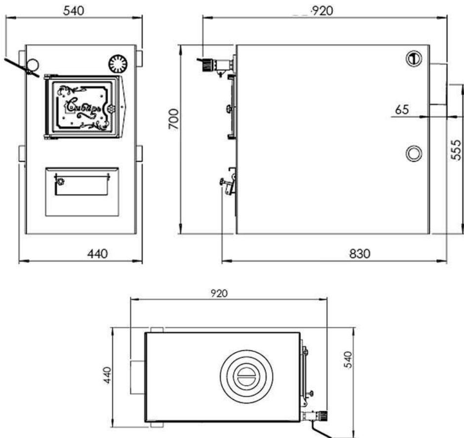
Рис.5. Габаритные размеры котла «Сибирь-КВО-Д» 15/20 кВт
