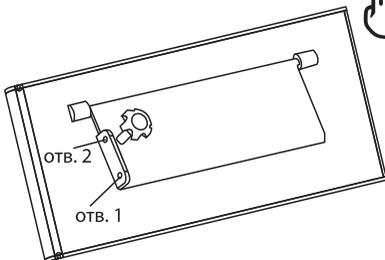
С целью оптимальной настройки количества подаваемого воздуха в зону горения котла, при использовании регулятора тяги, рычаг заслонки снабжен двумя отверстиями. В обычном режиме горения рекомендуется использовать отверстие [1] рычага заслонки для подключения регулятора тяги. Для увеличения объема поступающего воздуха в зону горения необходимо соединить регулятор тяги с отверстием [2] заслонки и произвести повторную настройку регулятора тяги.
