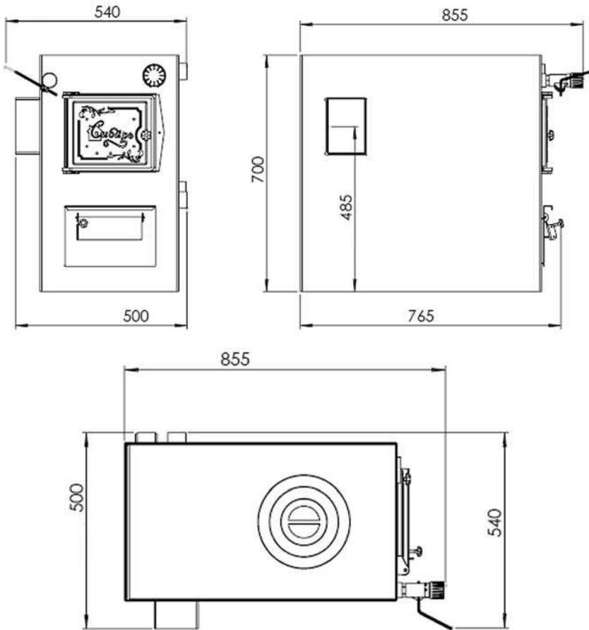
Рис.4. Габаритные размеры котла «Сибирь-КВО-Д» 12 кВт выход дымохода слева
