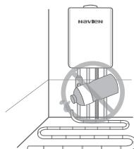
3. Котлы Navien Deluxe Соснащенны встроеными сетчатыми фильтрами отопительной воды. На обратном трубопроводе системы отопления, перед котлом, рекомендуется установить дополнительный косой сетчатый фильтр, для очистки отопительной воды от нежелательных примесей.
