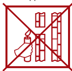
слабая тяга (Не используйте котел!)
