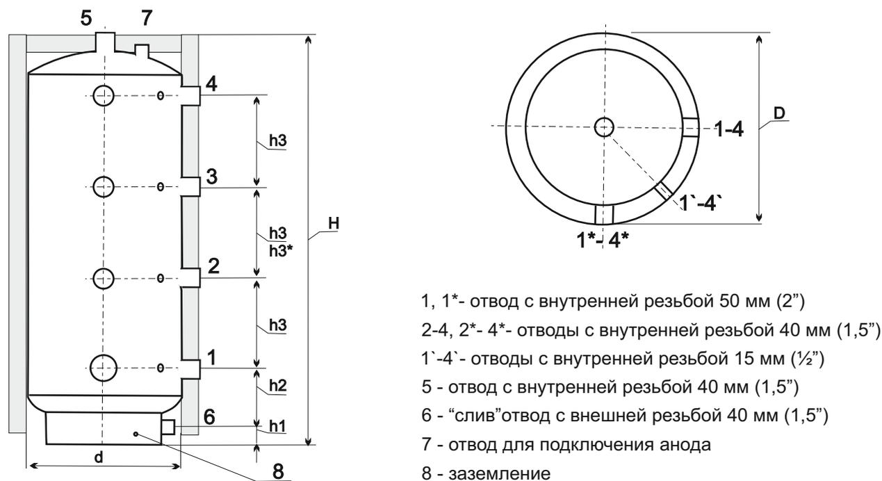
Рисунок 1. Схема подключения теплоаккумулятора серии ТА
