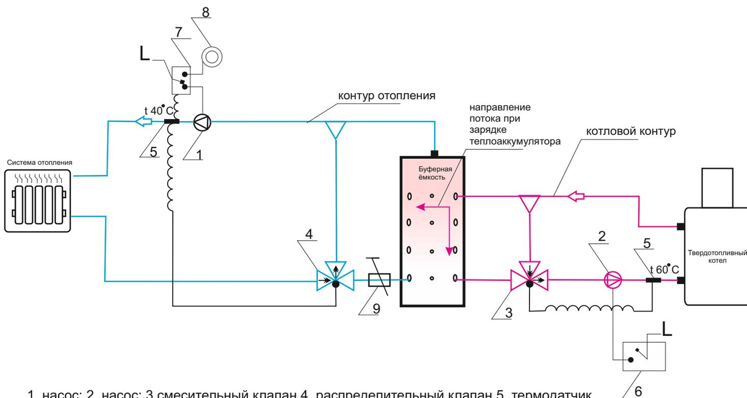
1. насос; 2. насос; 3.смесительный клапан 4. распределительный клапан 5. термодатчик
