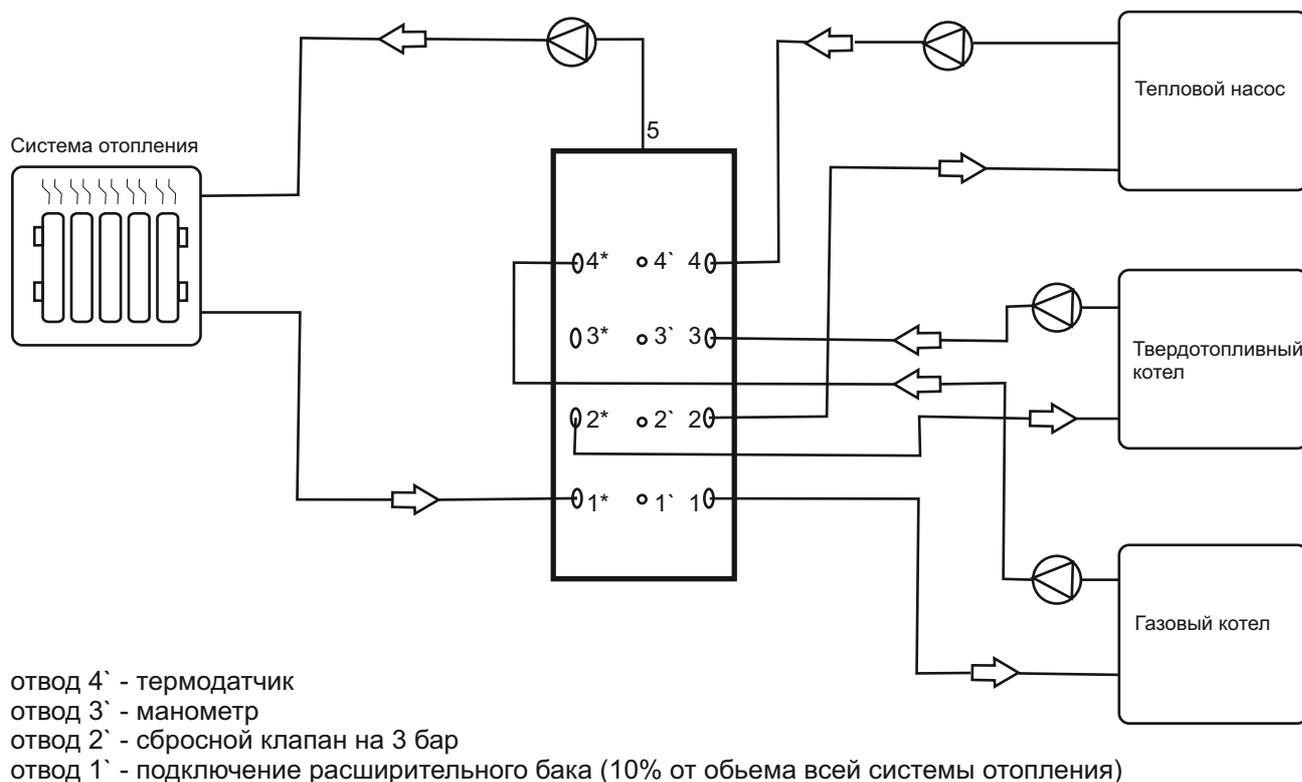
Рисунок 2. Принципиальная схема работы бака
