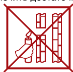
слабая тяга (Не используйте котел!)
