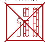
нет тяги (Не используйте котел!)
