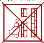
недостаточная тяга (Не используйте котел!)
