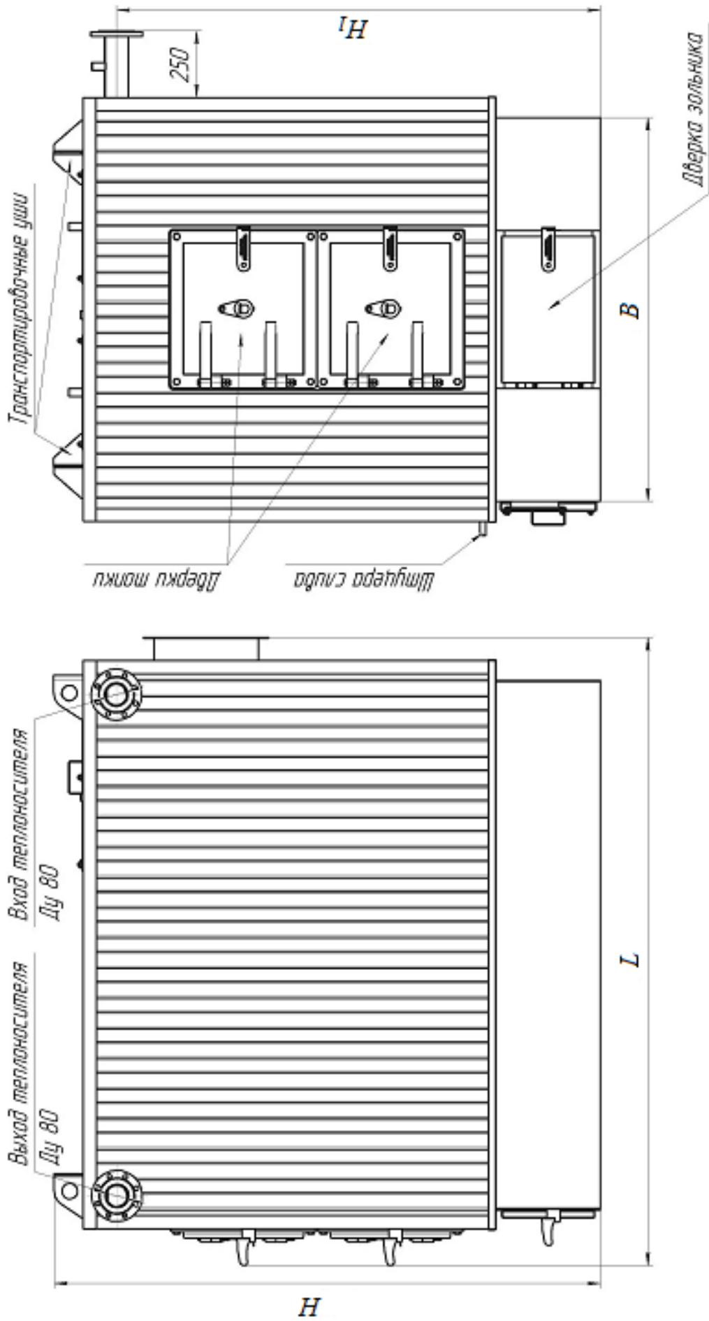
Рис. 1а. Габаритные и присоединительные размеры котла КВр.
