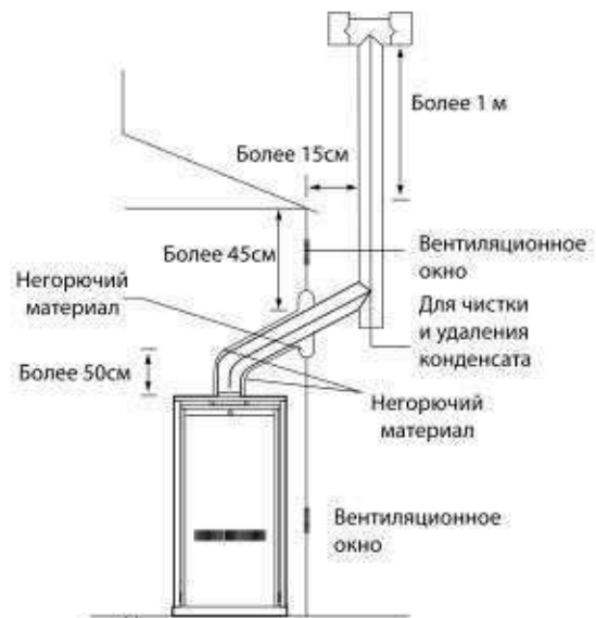
При отсутствии дымохода
