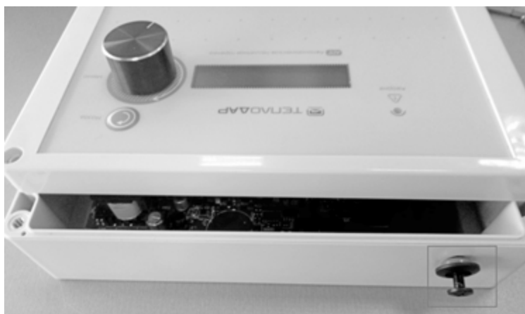
Рис. 6. Удаление заглушки из отверстия для антенны
