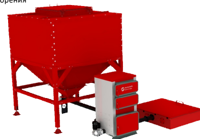
Исполнение под монтаж в модульную котельную. Q Eko Lux 25 кВт / бункер 4000 л / автоматическое золоудаление / бункер золы 800 л уличный.
