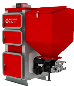
Q Eko Duo Lux 25 кВт / бункер 200 л / подготовка под золоудаление / увеличенная зольная камера
