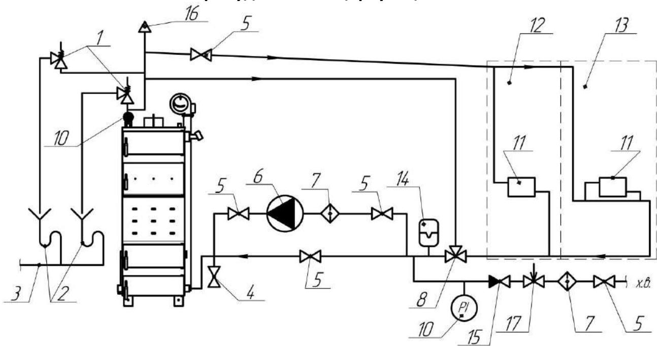
**Рис. 4 Схема подключения котла к закрытой системе отопления с принудительной циркуляцией**
