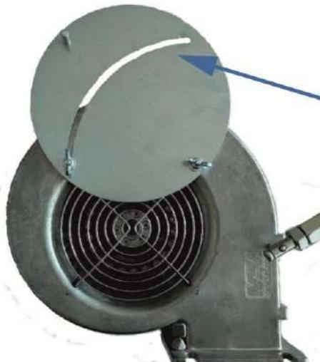
Открытое положение приёмного диффузора применяется в безветренную погоду, наиболее подходящее и часто применяемое.
