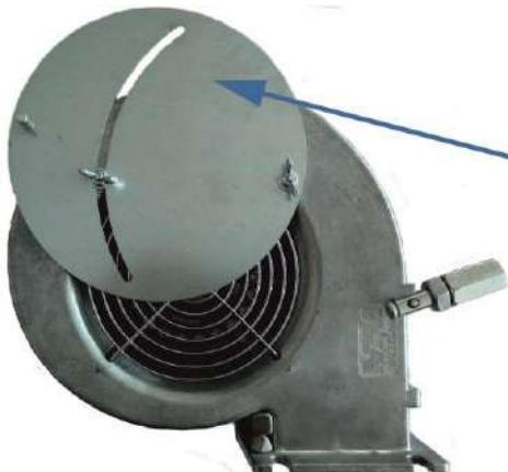
Среднее положение приёмного диффузора применяется при увеличении естественной тяги, например при ветреной погоде или слишком высокой дымовой друбе .
