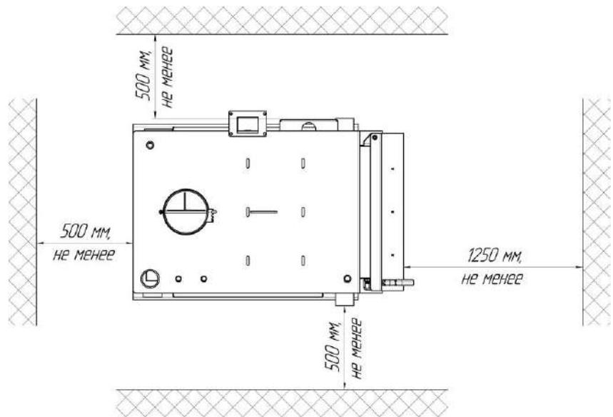
**Рис. 1 Схема установки котла**
