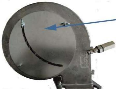
Закрытое положение приемного диффузора.
