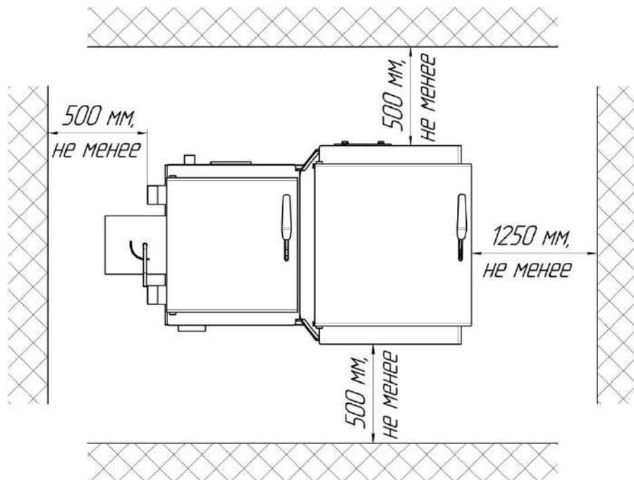
Рис. 1 Схема установки котла
