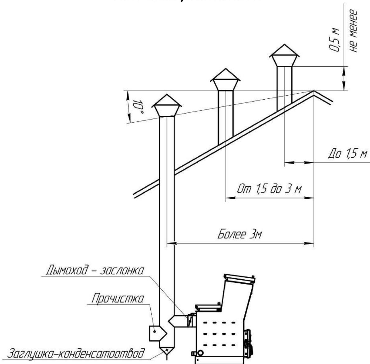
Рис. 2 Варианты установки дымовой трубы
