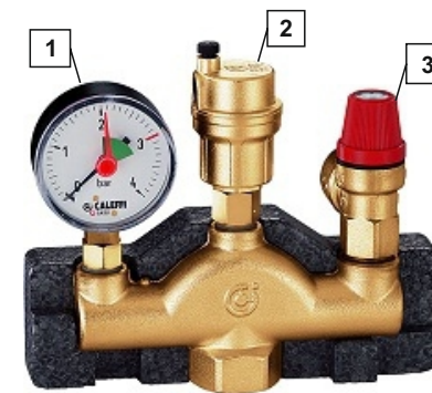
Рисунок 1. Группа безопасности котла: 1 - манометр, 2 - автоматический воздухоотводчик, 3 - предохранительный клапан на 1,5 бара.
