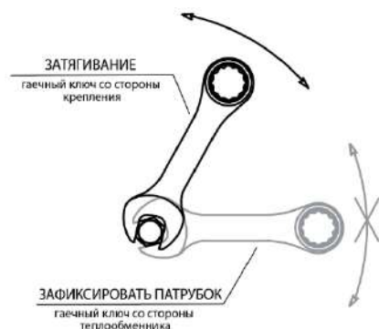
Рис. 5. Подключение к системе подачи теплоносителя
