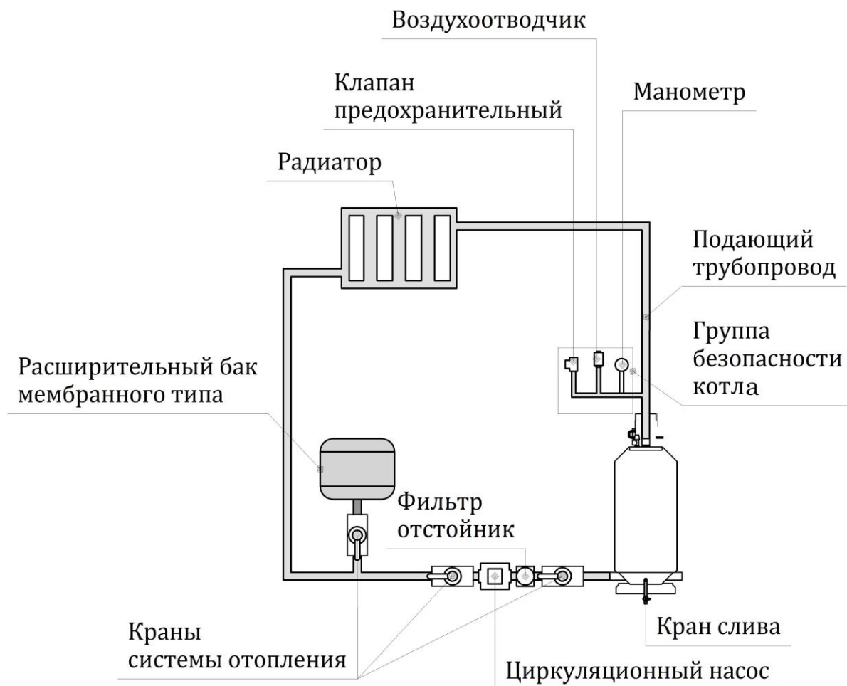
Рисунок 14 – Схема закрытой системы отопления с принудительной циркуляцией
