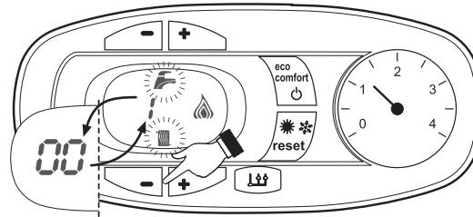
**Рис. 18. Режим TEST**
