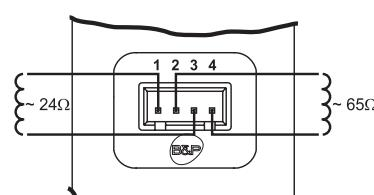
**Рис. 17. Электрический разъем для подключения газового клапана**
