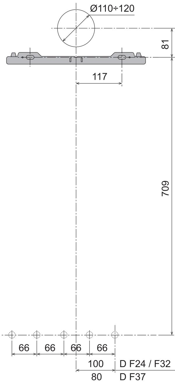
Рис. 26. Настенные отверстия
