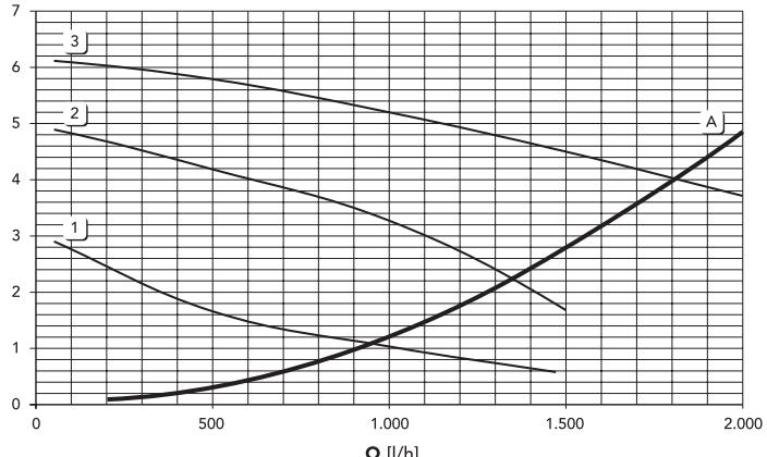
A – потери нагрузки в котле; 1, 2, 3 – скорости циркуляционного насоса
