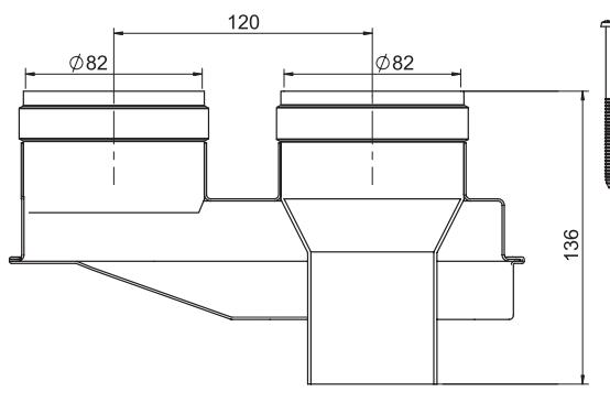
Рис 14. Адаптер для раздельных труб, код 010031X0
