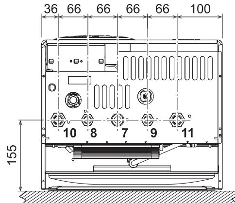
Рис. 23. Вид снизу DIVAtech D F24/F32
