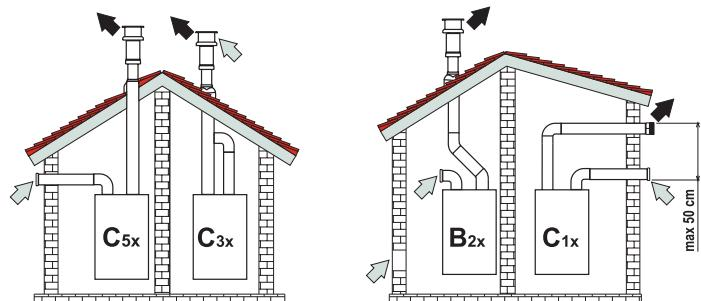
Рис 13. Примеры присоединения с помощью раздельных труб
