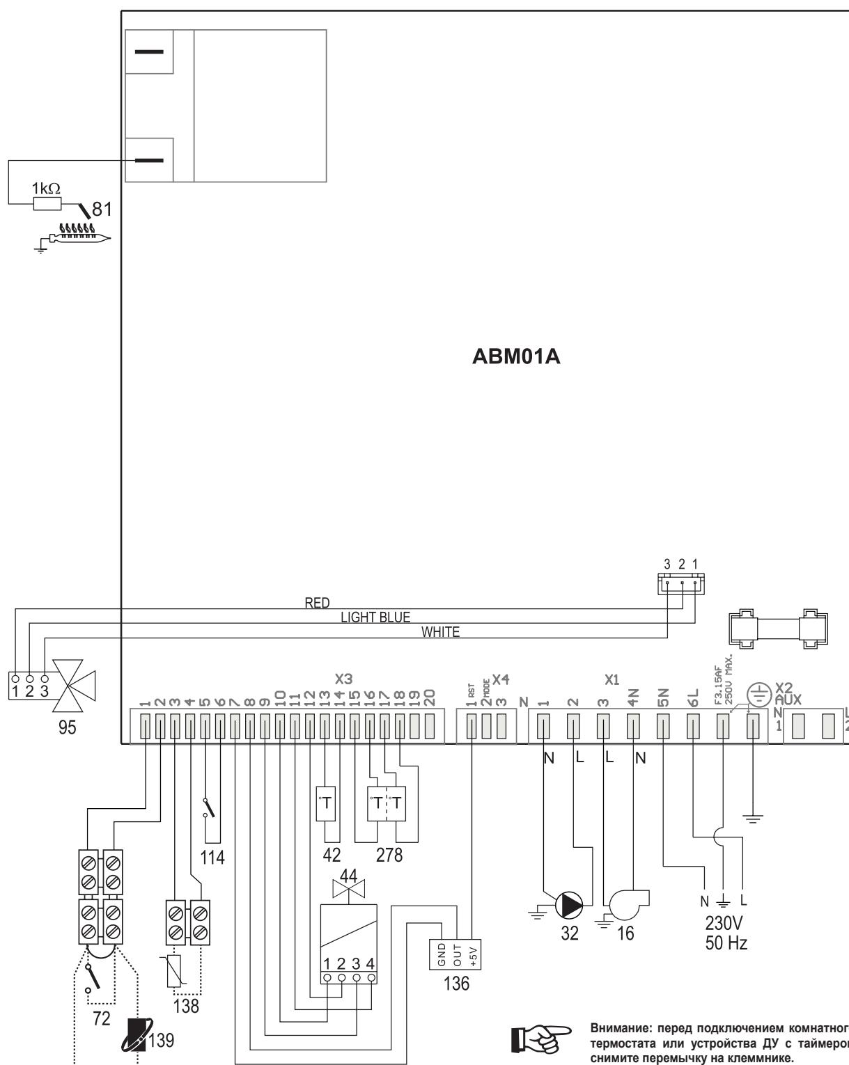
Рис. 31. Электрическая схема
