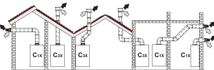
Рис. 11. Примеры присоединения с помощью коаксиальных труб
