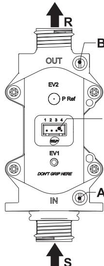
**Рис. 16. Газовый клапан**
