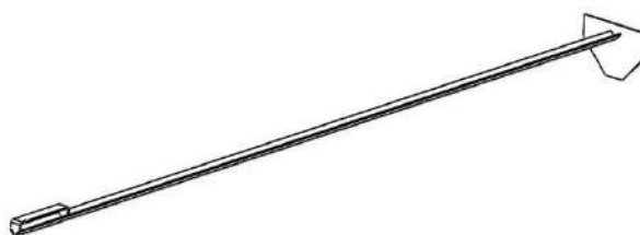
поз. 4 –Очиститель котла
