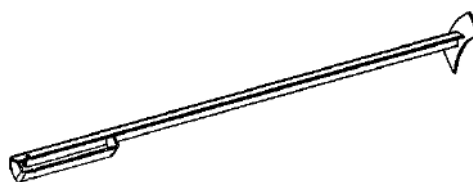
поз 2 – Очиститель теплообменника
