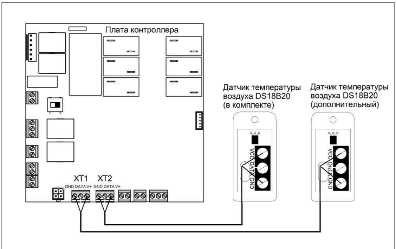
Рисунок 33. Схема подключения датчиков температуры воздуха
