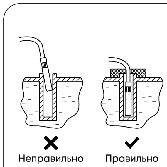
Рисунок 16 - Установка датчика температуры
