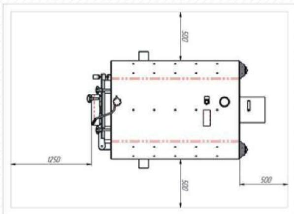
Такая установка котла обеспечит лёгкий доступ к его отдельным частям, что необходимо для его правильной эксплуатации и консервации. Когда это требование невыполнимо, такие поверхности должны быть защищены листовым асбестом или войлоком, смоченным в глиняном растворе. Поверх этого слоя укладываются стальные листы. Перед топочной дверцей на сгораемом или трудно сгораемом полу необходимо предусмотреть металли-
