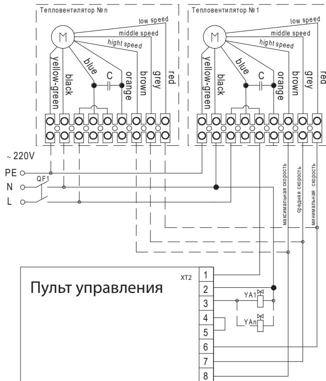
При подключении по схемам указанным выше (стр. 16-17) регулировка температуры помещения осуществляется при помощи открытия/закрытия электромагнитного клапана (без выключения функции вентиляции).
