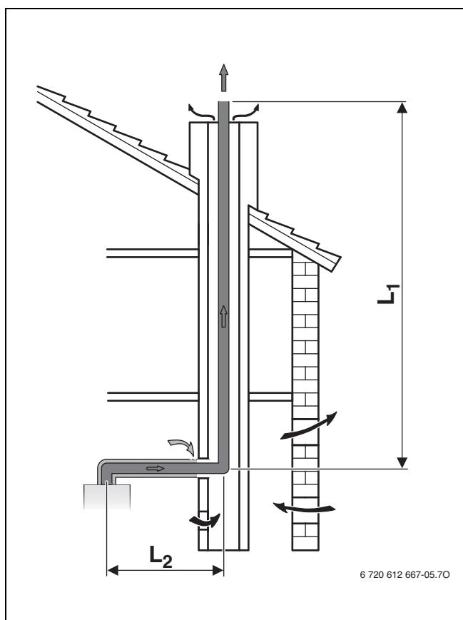
Рис. 7 Дымовая труба в шахте по В<sub>33(х)</sub>
