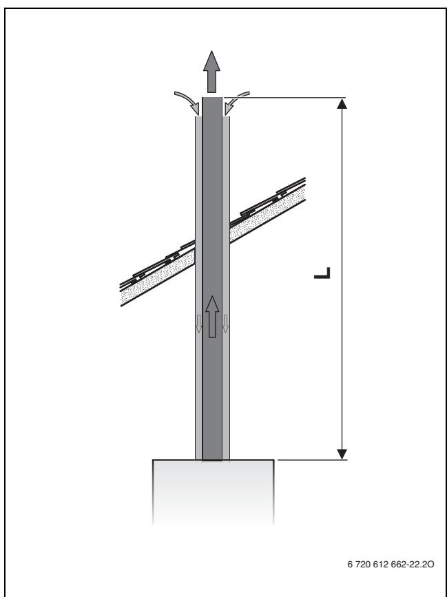
Рис. 13 Вертикальный отвод дымовых газов по С<sub>33(х)</sub>
