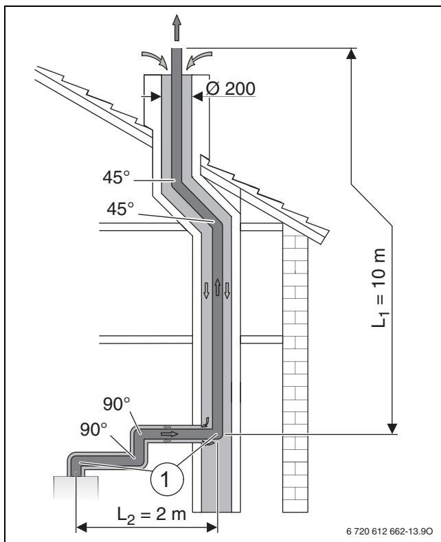
Рис. 16 Монтажная ситуация с отводом дымовых газов по С93(х)
