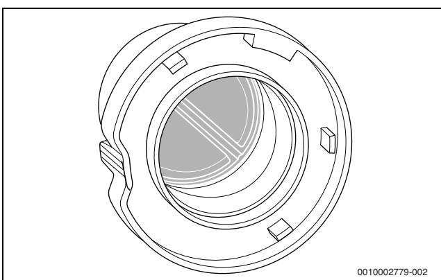
Рис. 54 Мембра на в смесительном устройстве
