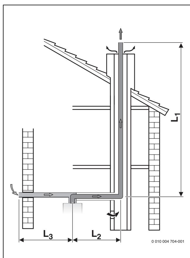
Рис. 9 Труба отвода дымовых газов в шахте по С<sub>53(х)</sub>
