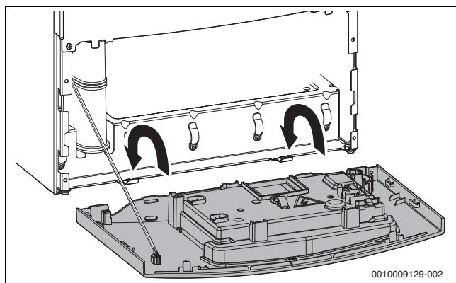
Рис. 23 Установите блок управления в положение для обслуживания
