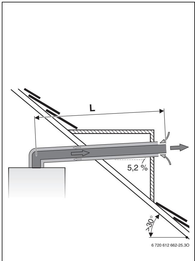
Рис. 12 Горизонтальный отвод дымовых газов по С<sub>13(х)</sub>
