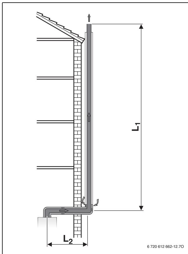
Рис. 15 Дымовая труба по фасаду по  $C_{53(x)}$
