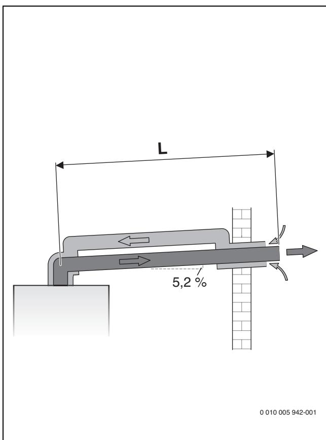
Рис. 11 Горизонтальный отвод дымовых газов по С<sub>13(х)</sub>
