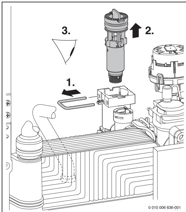
Рис. 56 Проверка сетчатого фильтра в трубе холодной воды
