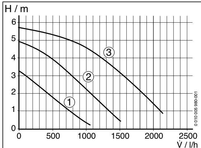
Рис. 34 Графическая характеристика насоса отопительного контура
