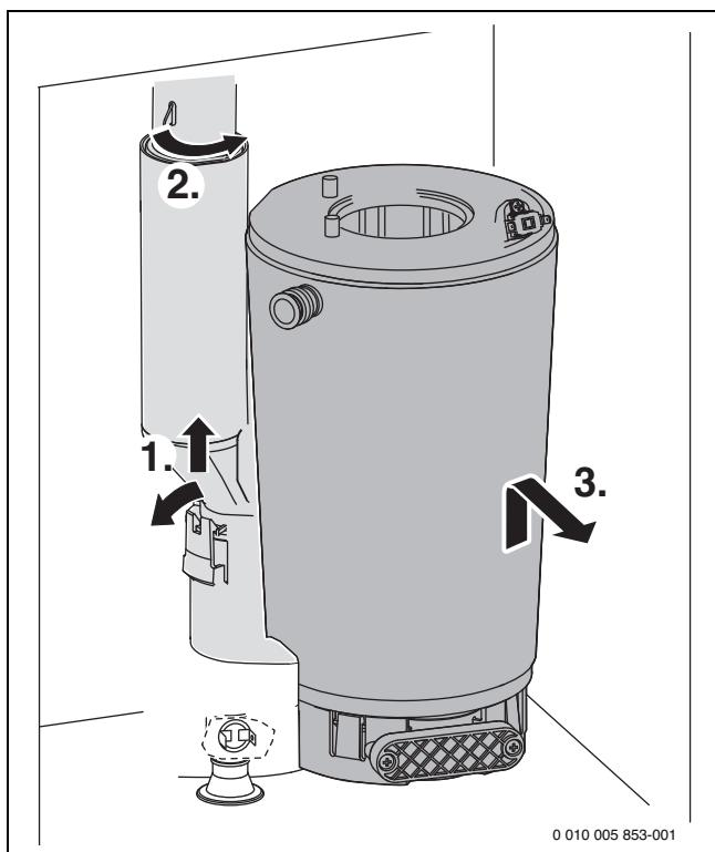
Рис. 65 Демонтаж теплообменника
