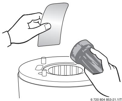
Рис. 51 Проверка наличия грязи в теплообменнике
