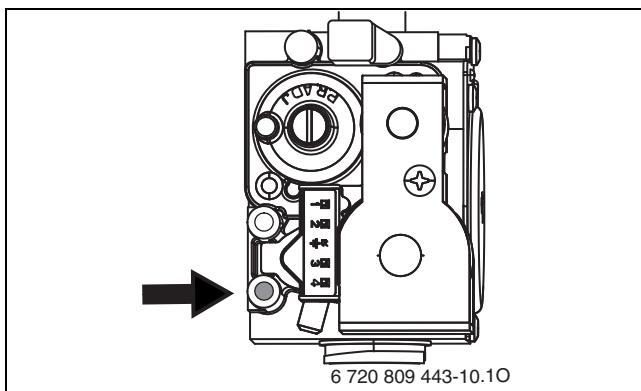
Рис. 42 Штуцер для измерения подаваемого давления газа
