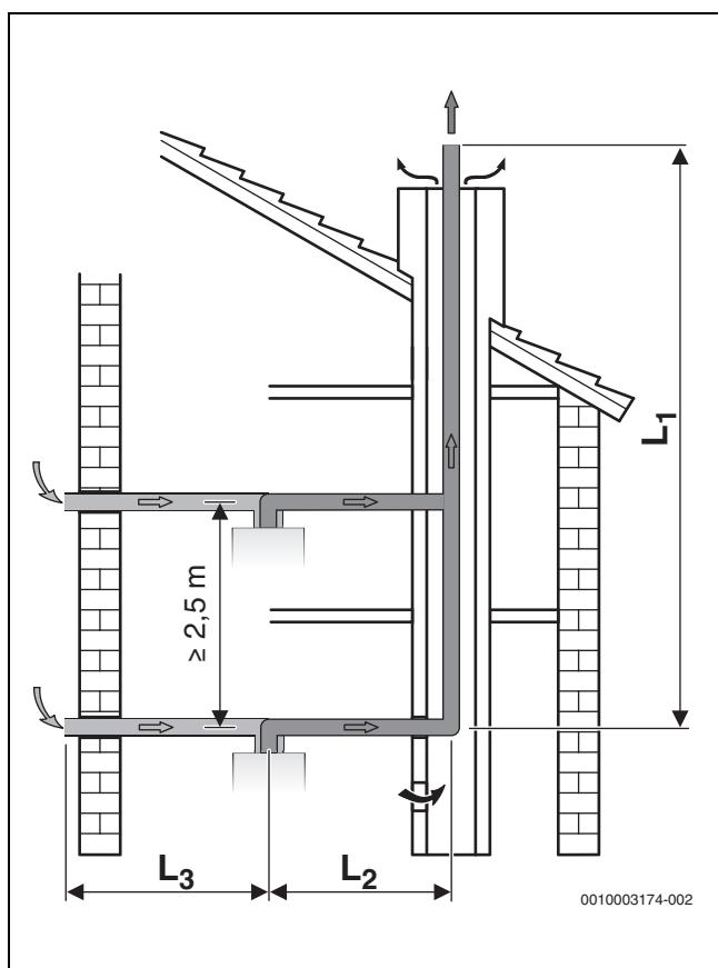
Рис. 18 Подключение нескольких котлов с раздельными трубами по С<sub>83(х)</sub>
