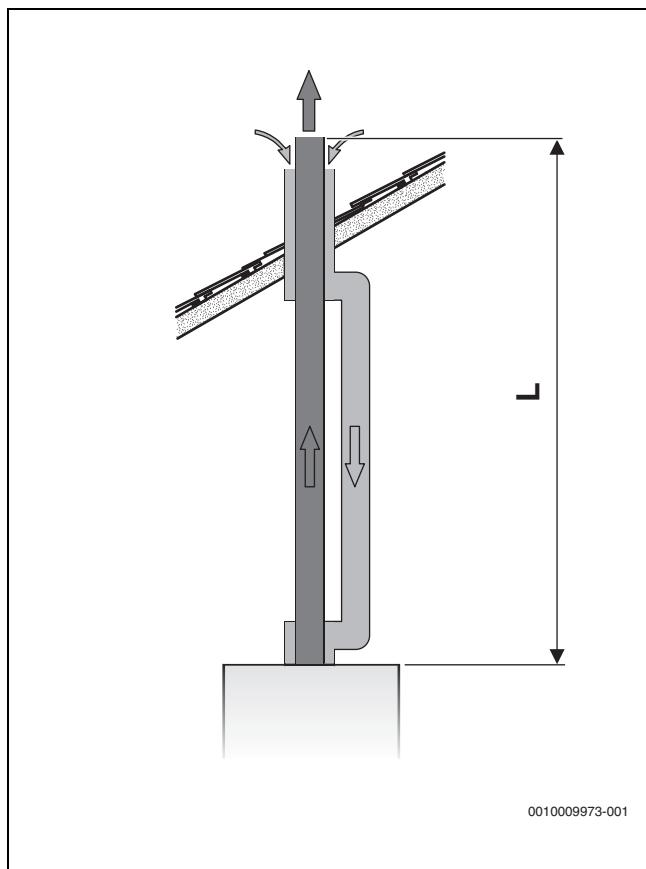
Рис. 14 Вертикальный отвод дымовых газов по  $C_{33(x)}$
