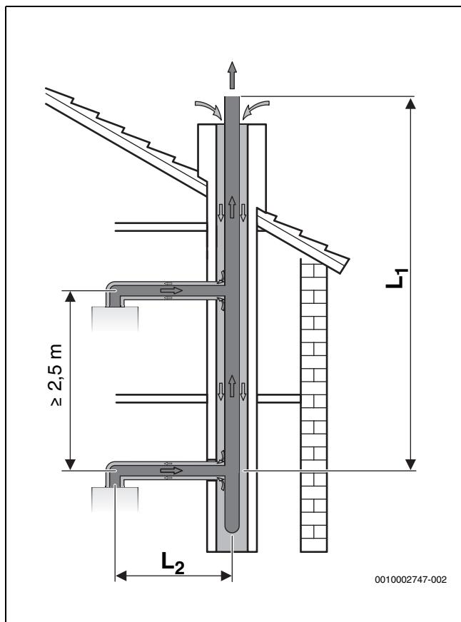
Рис. 17 Подключение нескольких котлов с концентрической трубой по С<sub>43</sub>
