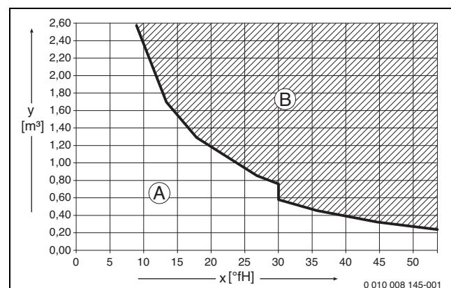
Рис. 20 Требования к воде для заполнения и подпитки в  $^{\circ}\text{fH}$  для котлов  $< 50 \text{ кВт}$
