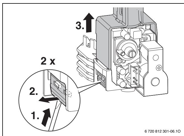
Рис. 61 Демонтаж газовой арматуры
